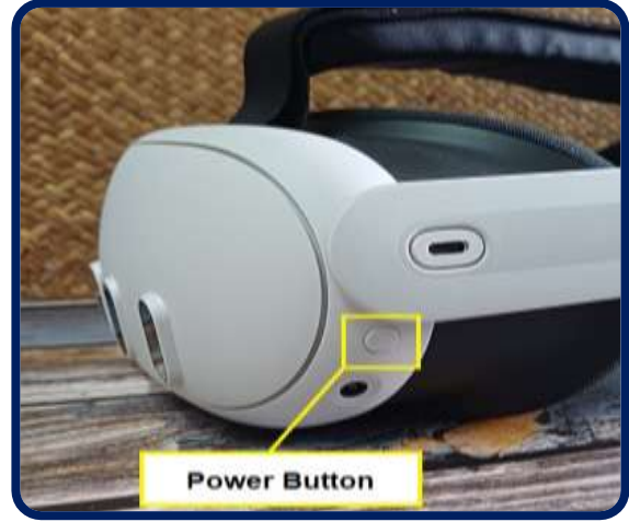
Şekil 2. Headset güç düğmesi konumu
