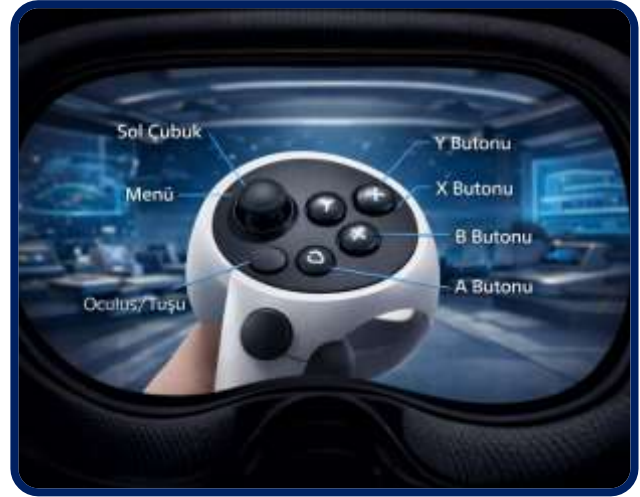
Şekil 3. Kumanda düğmeleri ve joystick açıklaması
